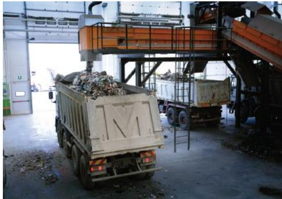
**Pressa imballatrice:** il materiale di sopravaglio viene caricato nella pressa mediante nastri trasportatori ove viene pressato e imballato in balle reggiate che mediante un caricatore a pinza vengono caricate sul camion destinato alla discarica, in caso di forte vento il materiale pressato viene ulteriormente filmato al fine di evitare dispersioni nelle fasi di spostamento.
