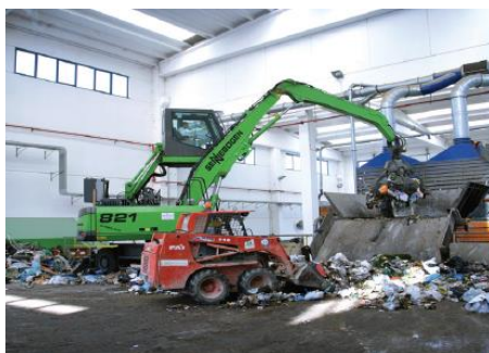
Figura 5 - Mezzo sollevatore tipo Polipo
